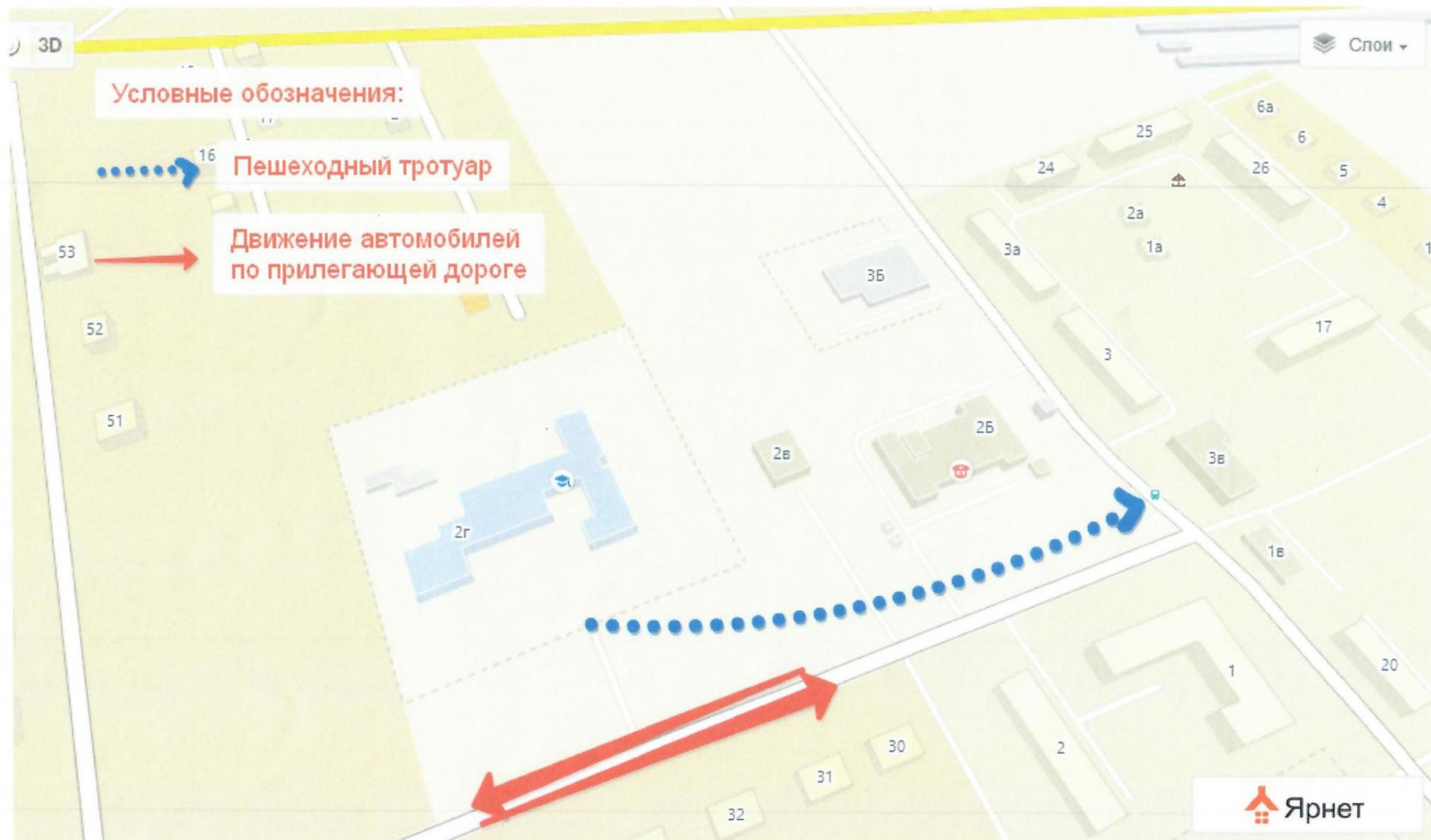
План – схема разметки дорожных знаков на прилегающей к школе дороге
